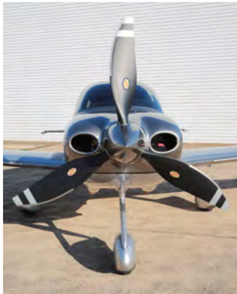
As enormes pás do conjunto de hélice são feitas em fibra de carbono e garantem a boa tração em grandes altitudes. Na página ao lado a manete única típica dos Cirrus e ainda o indicador de ângulo de ataque. Mais um artifício para aumentar a segurança.
