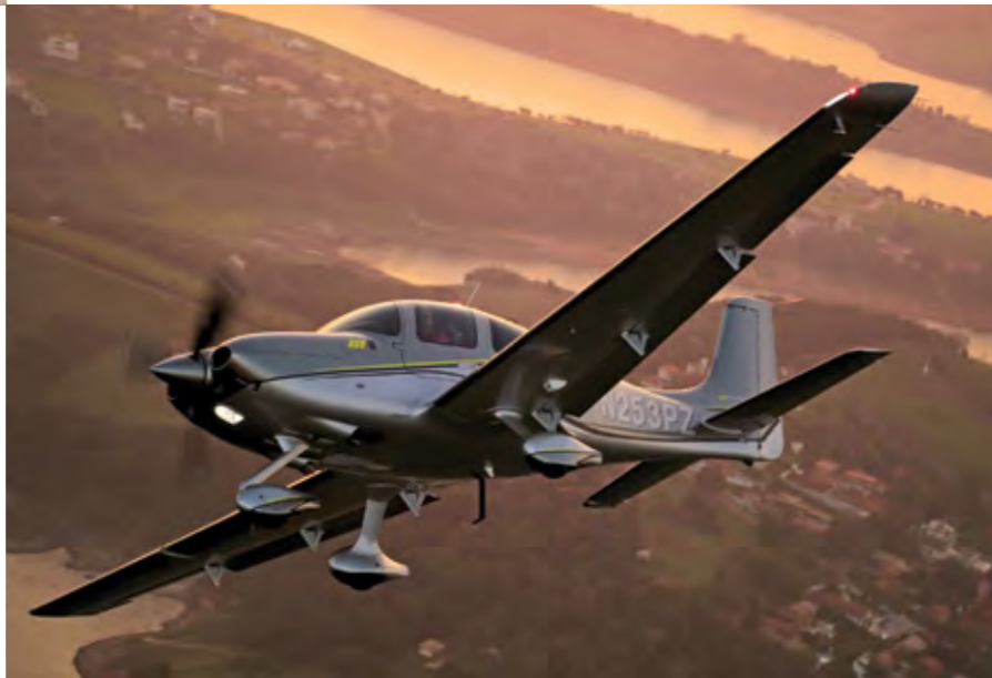
As enormes pás do conjunto de hélice são feitas em fibra de carbono e garantem a boa tração em grandes altitudes. Na página ao lado a manete única típica dos Cirrus e ainda o indicador de ângulo de ataque. Mais um artifício para aumentar a segurança.
