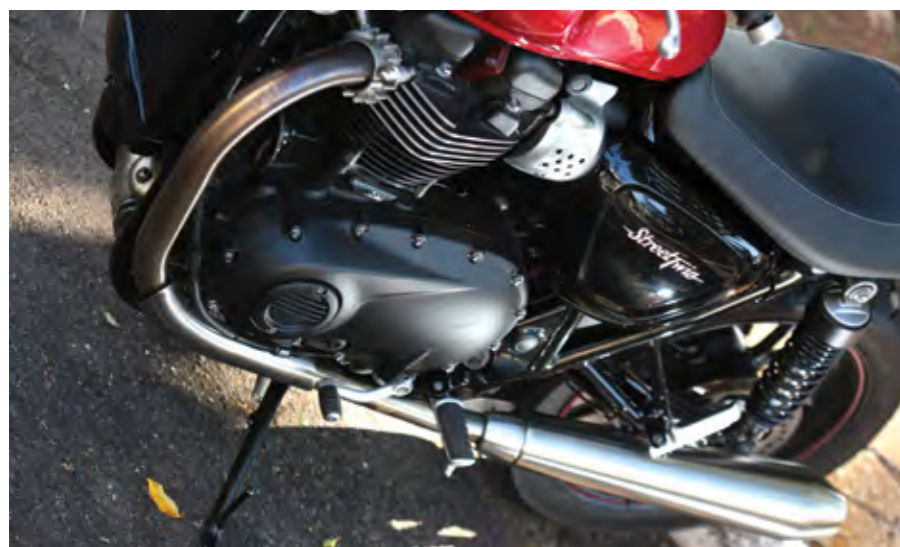
Acima o tanque de pouca capacidade limita o alcance. Abaixo o motor que ganhou refrigeração à líquido.
