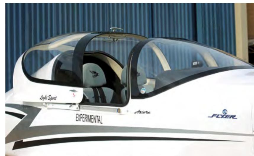
Detalhes bem acabados nos elementos de cabine. O canopy corre para trás abrindo um bom acesso ao interior da aeronave.
