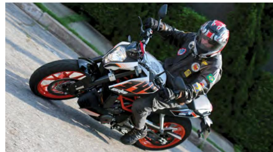
O painel digital é muito completo e de fácil visualização. Na frente da Duke impera a suspensão invertida e o bom disco de freio com 300mm de diâmetro.
