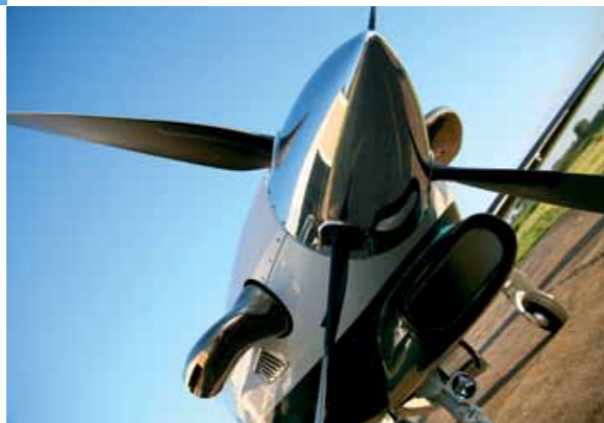
No detalhe a abertura do bagageiro dianteiro. Abaixo a tradicional entrada de ar da PT6, que neste modelo conta com separador inercial de partículas. No rodapé, a usina de cana de álcool, o típico cenário para esse avião.
