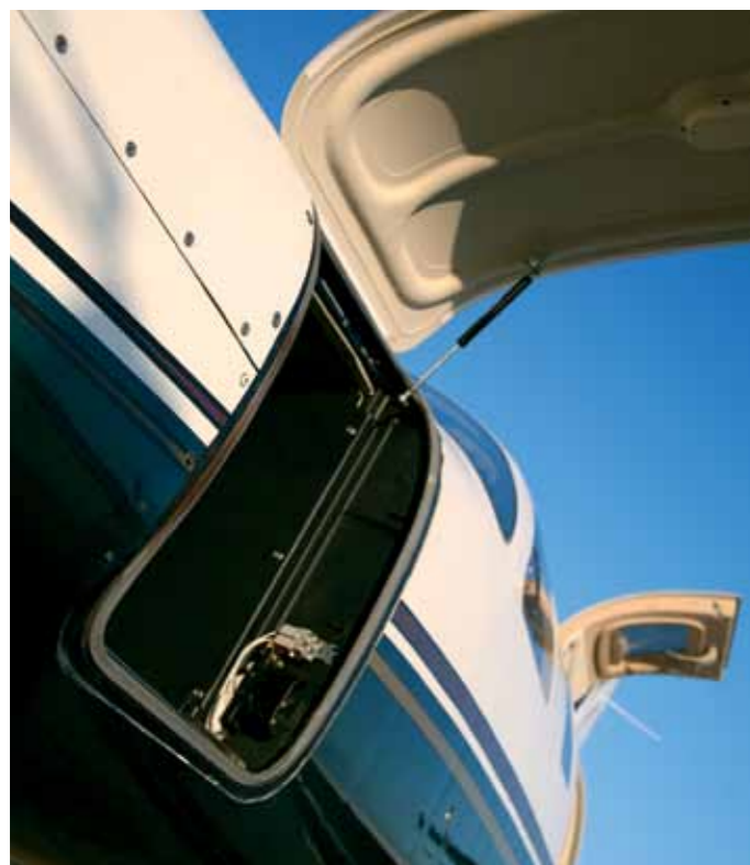
No detalhe a abertura do bagageiro dianteiro. Abaixo a tradicional entrada de ar da PT6, que neste modelo conta com separador inercial de partículas. No rodapé, a usina de cana de álcool, o típico cenário para esse avião.
